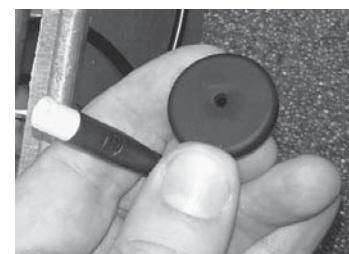
Retirez à présent le flotteur de la chambre à tambour en tirant le câble et l'écrou via l'étrier. Déposez l'obturateur du milieu et placez-le dans le trou de gauche.
