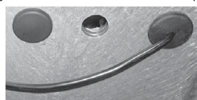
Führen Sie den Steckanschluss des Schwimmers zuerst durch den Bügel in der Einlasskammer. Achten Sie darauf, dass der Schwimmer im Gegensatz zu der Schwerkraftversion um 180° gedreht werden muss! Schieben Sie dann die Mutter über den Stecker und befestigen Sie diese an dem Schwimmer.
