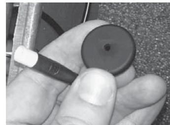
Entfernen Sie jetzt den Schwimmer aus der Trommelkammer in dem Sie Kabel und Mutter durch den Bügel ziehen. Platzieren Sie den mittleren Blindstopfen in der linken Öffnung.
