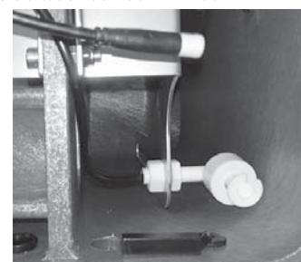
Führen Sie den Stecker durch die Durchführung nach außen und montieren Sie darauf die Gummiaabdichtung. Evtl. müssen Sie mittels eines Messerschnittes das Loch der Durchführung ein wenig vergrößern. Platzieren Sie nun die Gummiaabdichtung in dem mittleren Loch.
