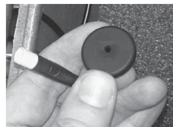
Haal nu de vlotter uit de trommelkamer door de kabel en de moer via de beugel te steken. Verwijder de blinde stop uit het midden en plaats deze in het linkse gat.
