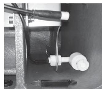
Steek de stekker aansluiting door het gat naar buiten en steek deze vervolgens door de rubber dop. Het gat van de rubber dop kan eventueel wat worden vergroot door er een klein sneetje met een scherp mes in te maken. Steek de rubber dop in het middelste gat.
