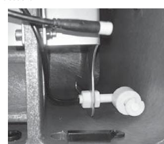
Tirez le branchement de fiche à travers le trou vers l'extérieur et tirez-le ensuite à travers le bouchon caoutchouc. Le trou du bouchon caoutchouc peut éventuellement être légèrement agrandi en pratiquant une incision avec un couteau affûté. Placez le bouchon caoutchouc dans le trou du milieu.
