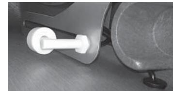
Entfernen Sie den Gummistopfen des Schwimmers aus dem Gehäuse und lösen Sie den Stecker. Schieben Sie den Stecker durch das Gummi so dass dieser frei wird.
