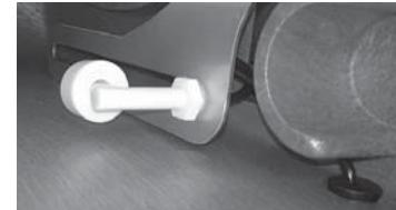
Verwijder de rubber stop van de vlotter uit de behuizing en trek de stekker aansluiting los. Duw de stekker aansluiting door de rubber dop zodat deze vrij is.
