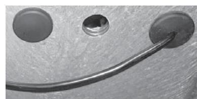
Steek de stekkeraansluiting van de vlotter nu als eerste door de beugel in de inlaatkamer. Let er hierbij goed op dat de vlotter 180 graden omgedraaid staat t.o.v. de zwaartekracht opstelling! Monteer daarna de moer over de stekker en schroef deze vast op de vlotter.
