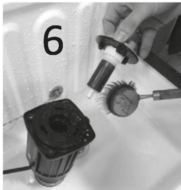
Rotor met water en borstel schoonmaken
