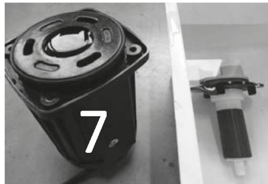
Zet pomphuis rechtop en vul deze met een milde ontkalker (zoals schoonmaakazijn). Leg de rotor in een plastic kom/bakje gevuld met hetzelfde anti kalk middel en laat beiden 24 uur staan. Na 24 uur afspoelen met water en pomp weer assembleren.
