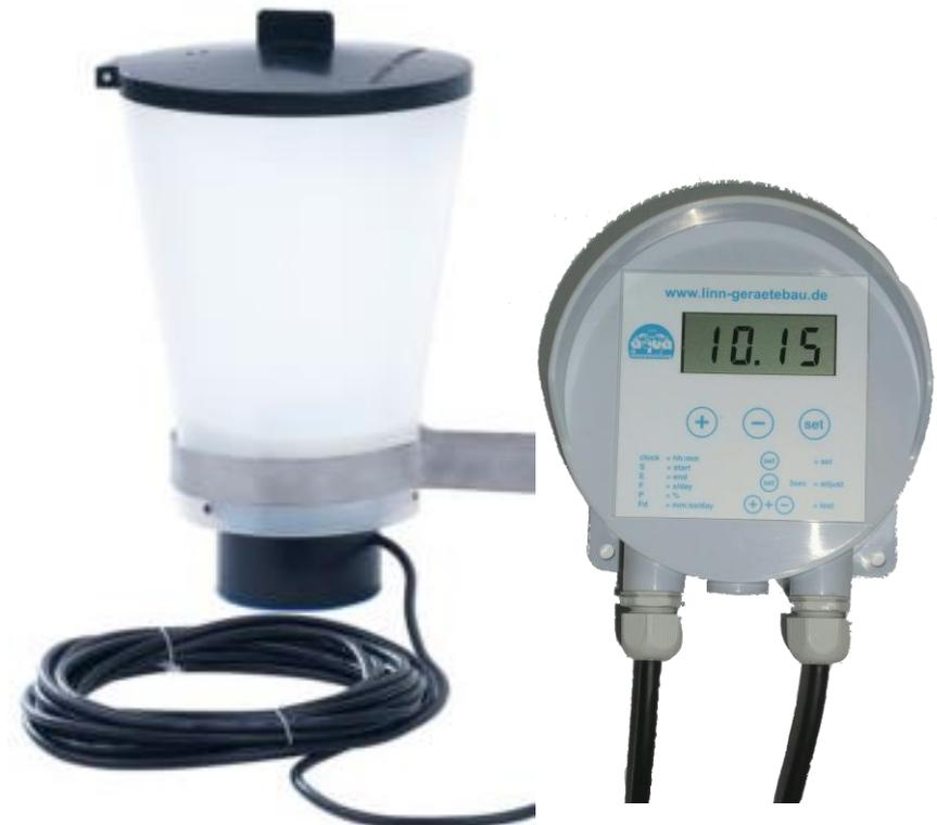
Mit diesem LINN- Futterspender haben Sie die Möglichkeit, Ihre Fische nach Ihren Wünschen automatisch zu füttern! Das Futter wird mit einem kleinen Getriebemotor und Dosierfingern genau in der gewünschten Menge aus dem Futterbehälter transportiert. Fütterhäufigkeit und –dauer lassen sich mit der neuen Futteruhr sekundengenau und einfach einstellen. Bitte beachten Sie die nachfolgenden Punkte.
